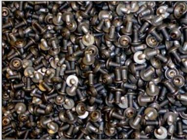
ネジ転造工程前の100 %クラックフリーの圧造部品
