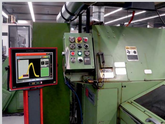
ITW社冷間ヘッダー機に取り付けられたFoxmatic技術を搭載したSK 800プロセスモニター
