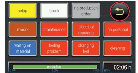
**停止理由コード**：稼働中断時にカスタマイズできる停止理由コードを選択します。必要により、停止理由コードが入力されない場合は機械をロックすることが出来ます。
