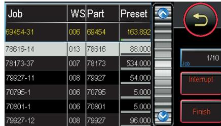
**ジョブデータ**：画面上のジョブリストから目的のジョブを選択します。クイックダイヤルでスピーディーにリストのスクロールが出来ます。
