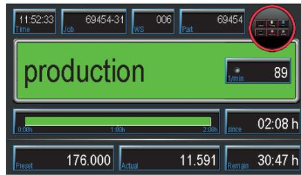
**ホーム画面**：現状機械状況、生産速度、生産進捗、完了までの残り稼働時間
