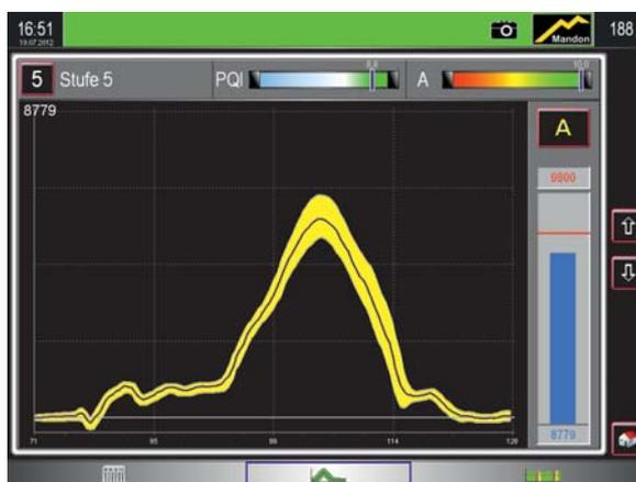
Mandonic自動エンベロップシステムは、生産稼働時の通常荷重ばらつきを考慮してエンベロップ監視幅を設定します。不必要な機械停止無く高精度にプロセスエラーを検出します。
